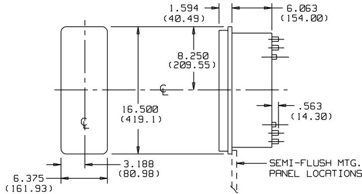
PANEL DRILLING AND CUTOUT FOR SEMI-FLUSH MTG.
