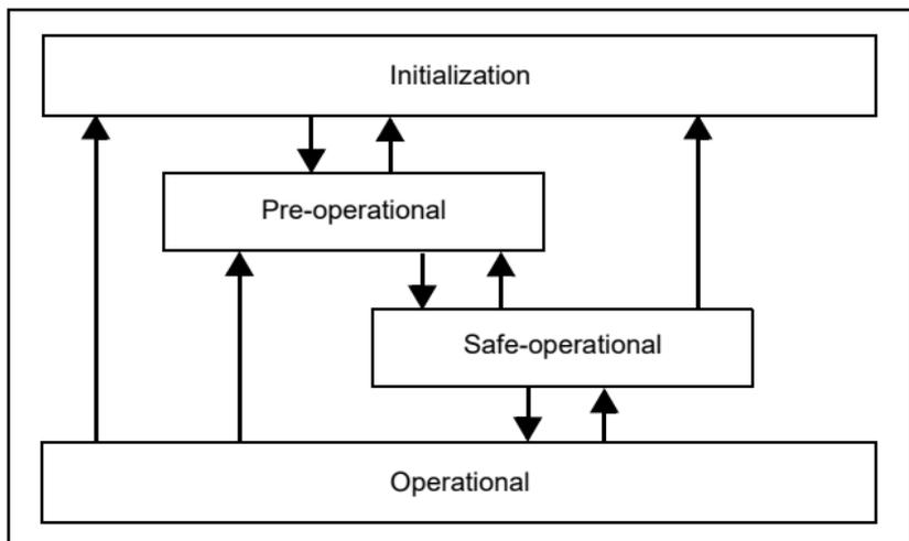
适配器模块启动后直接进入 INIT（初始化）状态。此后适配器模块可以切换到 预运行 (PREOP) 状态。在 PREOP 状态下，允许 EtherCAT 邮箱通讯，SDO 可以访问 CoE 对象。
