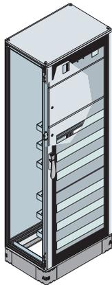
Estructura montada serie IS2 dim. 1800 x 600 x 400 mm (1805 x 594 x 410 mm. HxAxP exteriores) IP65 versión modular, con panel instrumentos y puerta transparente, paneles DIN, zócalo H = 100 mm (tapas incluidas).
