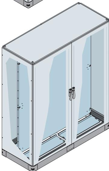
Estructura montada serie IS2 dim. 2000 x 1600 x 600 mm (2105 x 1610 x 610 mm. HxAxP exteriores) IP65 con puerta ciega, placa de montaje, paneles laterales, tapas entrada cables correderas y zócalo H = 100 mm (tapas incluidas).
