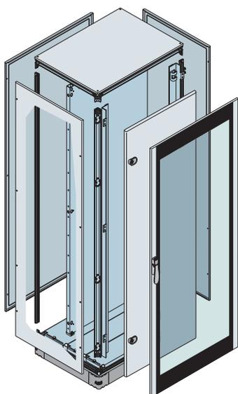
Estructura en kit serie IS2 dim. 2200 x 800 x 600 mm (2305 x 810 x 610 mm. HxAxP exteriores) IP65 con puerta transparente, contrapuerta, placa de montaje, paneles laterales, tapas entrada cables extraíbles y zócalo H = 100 mm (tapas incluidas).
