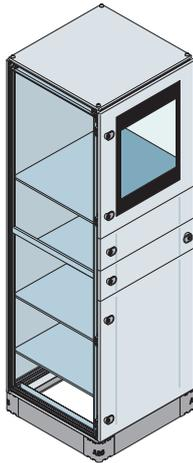
Estructura montada serie IS2 dim. 2000 x 610 x 610 mm (2105 x 610 x 610 mm. HxAxP exteriores) IP65 versión ordenador con puerta transparente para monitor, mesa para teclado, módulo para CPU, paneles laterales y zócalo H = 100 mm (tapas incluidas).
