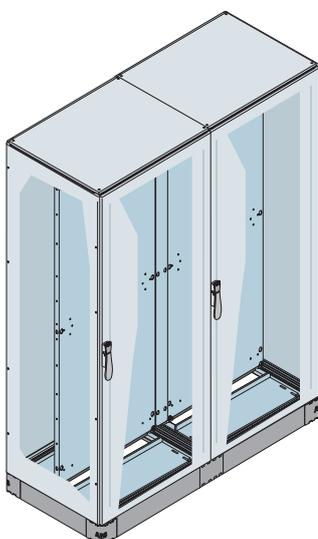
Dos estructuras montadas serie IS2 dim. 2000 x 600 x 600 mm (2105 x 1204 x 610 mm. HxAxP exteriores) IP65 con puerta ciega, placa de montaje, paneles laterales, tapas entrada cables correderas, kit de unión estructuras/placas y zócalo H = 100 mm (tapas incluidas).
