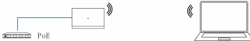
Abb. 12: „Smart Access Point“ mit PC verbinden (Access-Point Modus)
