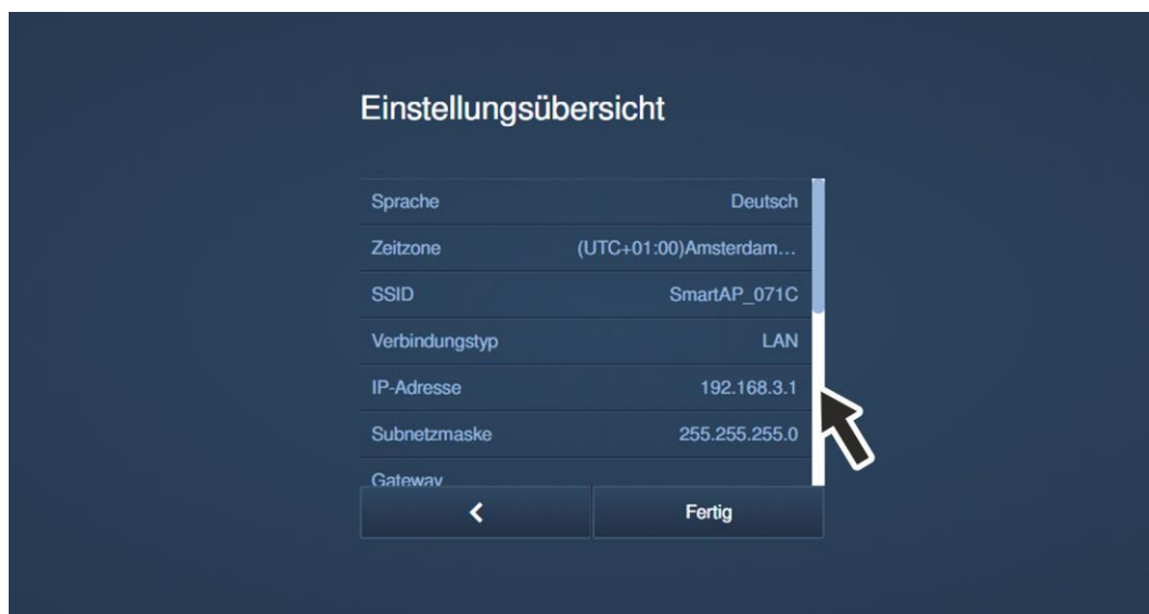
Abb. 29: Inbetriebnahme „Smart Access Point“: Einstellungsübersicht
