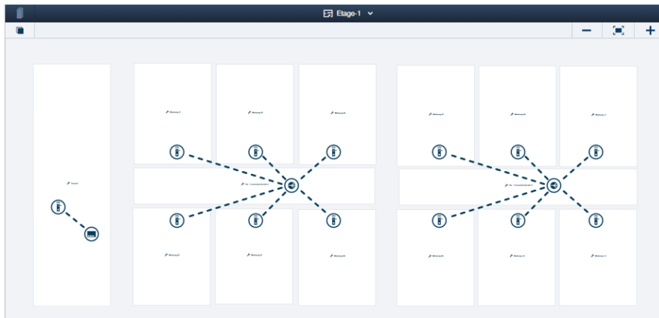
Abb. 61: Gebäudestruktur: Wohngebäude mit mehr als 10 Meter Übertragungsstrecke und Funksignalhemmung durch Feuerschutzwände
