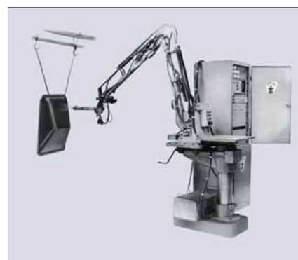
3 Version 1969 du robot de peinture Trallfa
