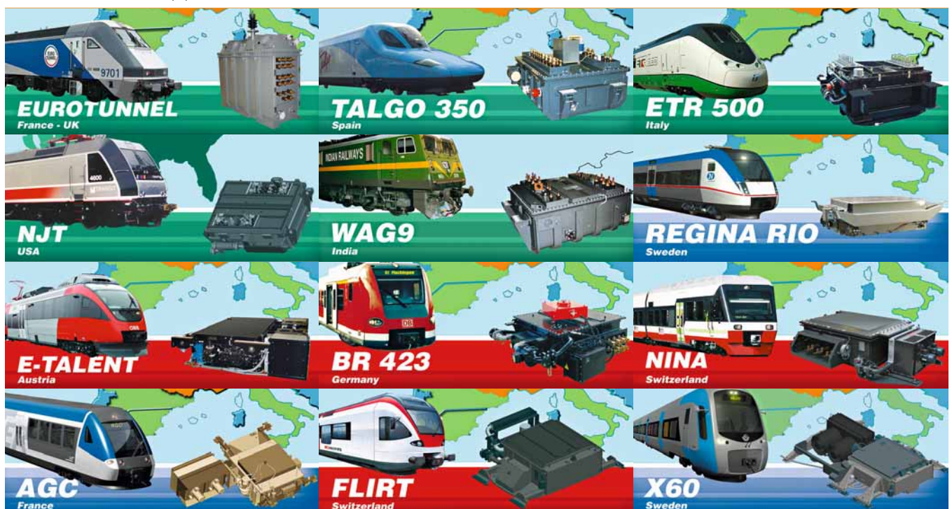
2 Panorama des trains équipés de transformateurs de traction ABB
