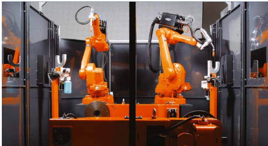
9 Cellule FlexArc® avec deux robots travaillant en tandem
