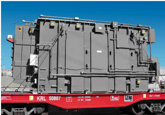
10 Transformateur ConEdison ultrasilencieux avec écrans insonorisants
