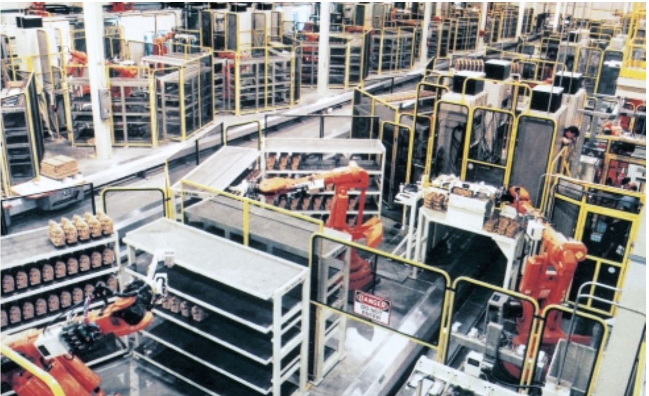
5 Fonderie d'aluminium de l'usine Windsor de Ford, Canada. Il s'agit de l'une des installations les plus modernes et les plus automatisées du monde. Plus de 100 robots à bras articulé et à portique d'ABB Flexible Automation y produisent des blocs et des têtes de culasses pour les types de moteurs les plus divers.
