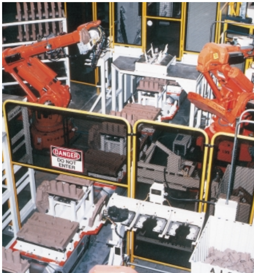
Assemblage d'un moule auprès de l'usine Windsor de Ford, Canada. Le moule est construit par pas successifs sur une palette qui se déplace d'une cellule de production à la suivante à l'aide d'un monorail.
