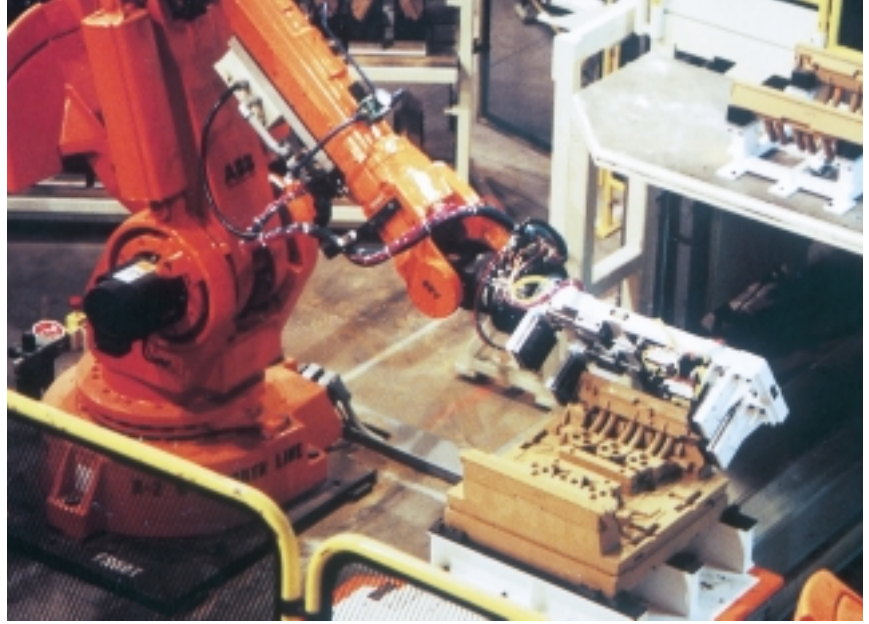
3 Articulation de poignet spéciale pour un robot de la version fonderie. Elle supporte le sable de moulage, la poussière, les giclures de liquides et les températures élevées.
