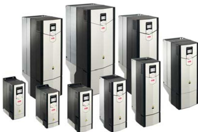
La familia de convertidores ACS880 está disponible para el rango de potencia comprendido entre 0,55 y 5600 kW y con tensiones de 230, 400, 500 y 690 V. Las clases de protección para los armarios son IP20, IP21 e IP55. El código para realizar el pedido del software de control de grúas torre es +N5650.
