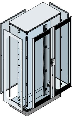
In Einzelteilen gelieferte Struktur Serie IS2 Abmessungen 2000x1200x600mm (2105x1210x610mm hxbxt außen) IP65 mit doppelten Tür mit Falzverschluss, auf Zwischenholm. Montageplatte, Seitenwände, zusammensetzbare Kabeleinführungsflansche und Sockel h=100mm (Flansche inbegriffen).
