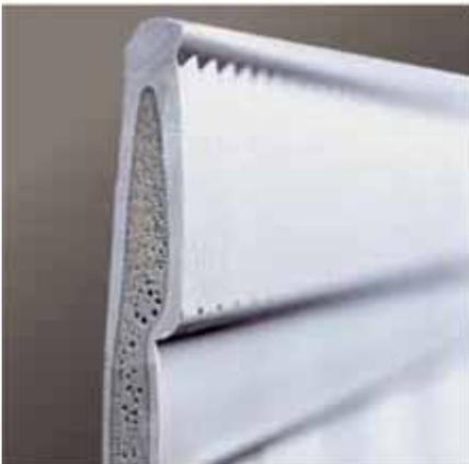
Die Gemini Schaltschränke werden mit dem Zweikomponenten-Spritzguss hergestellt: ABB SACE ist der erste Hersteller der Elektrobranche, der dieses Gussverfahren anwendet. Mit diesem Herstellungsverfahren erhält man eine „Sandwich“-Kombination zweier Materialien: Die kompakte externe Ummantelung sorgt in Verbindung mit dem Schaumstoffkern für einen maximalen Grad an Stoßfestigkeit (IK10), ohne dass härtende Substanzen beigefügt werden müssen.
