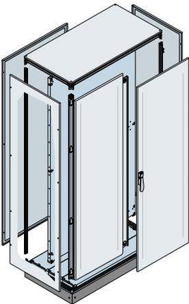
In Einzelteilen gelieferte Struktur Serie IS2 Abmessungen 2000x1000x600mm (2105x1010x610mm hxbxt außen) IP65 mit Doppeltür mit Falzverschluss, Montageplatte, Seitenwände, zusammensetzbare Kabeleinführungsflansche und Sockel h=100mm (Flansche inbegriffen).
