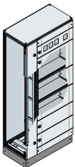
**Montierte Struktur Serie IS2 Abmessungen 1800x800x400mm (1805x794x410mm hxbxt außen) IP41 Version mit geschotteten Zellen Form 3, Kabelhochführung b=200mm mit Abdeckung für Geräte und Volltüren für PC-MCC, Sockel h=100mm (Flansche inkl.).**
