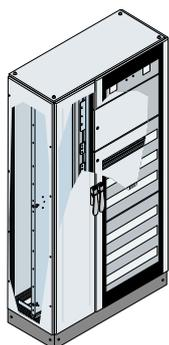
**Montierte Struktur Serie IS2 Abmessungen 1800x1200x400mm (1805x1210x410mm hxbxt außen) IP65 modulare Version mit Kabelhochführung b=400mm, Abdeckung für Geräte, DIN-Platten, Verkabelung auf Montageplatte und Sockel h=100mm (Flansche inkl.).**
