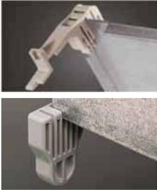
Die serienmäßig gelieferten Befestigungshaken und -stifte können ohne die Verwendung von Werkzeug angebracht werden und gestatten es, die Montageplatte im Schaltschrank auf sieben verschiedenen Tiefen zu befestigen. Zudem ermöglichen sie eine Positionierung auf drei zusätzlichen Ebenen.
