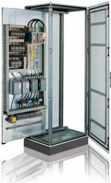
Bei den Schaltschränken mit Glastür gestattet der Nutzraum zwischen dem Glas und den Abdeckungen/der Innentür die Montage der meisten Komponenten, darunter: feste Leistungsschalter mit Drehgriff auf der Schaltfeldtür, Trennschalter OESA-OETL, Kompakt-Leistungsschalter Tmax, Druckknopftafeln.
