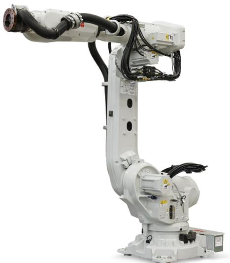
在150kg至300kg的同类产品中，IRB 6700性能最为突出。与其之前的版本相比，IRB 6700系列不仅结构刚性更好，无故障运行时间更长，性能提升且维修简化，其总拥有成本降低20%。
