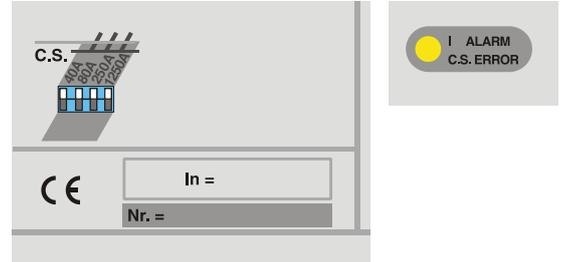
Sélection du courant primaire des capteurs de courant
