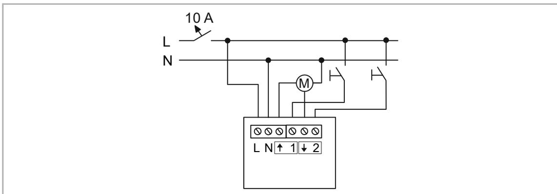
Abb. 4: Elektrischer Anschluss
