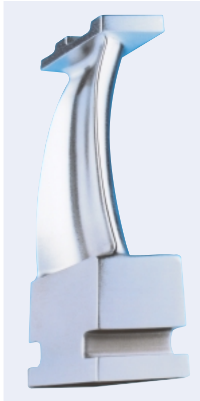
Aube à rendement élevé avec vrillage et courbure qui permettent de tenir compte de la répartition irrégulière de l'écoulement et de la pression sur la hauteur de l'aube. 8
