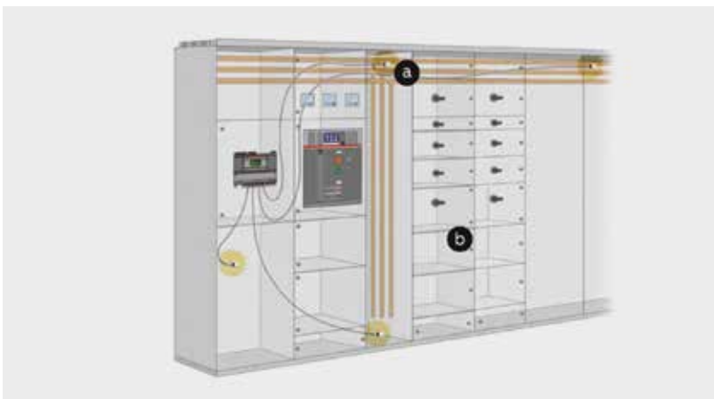
รูปที่ 2 a ระบบบัสบาร์ทั้งในแนวตั้งและแนวนอน b ตู้ของเซอร์กิตเบรกเกอร์
