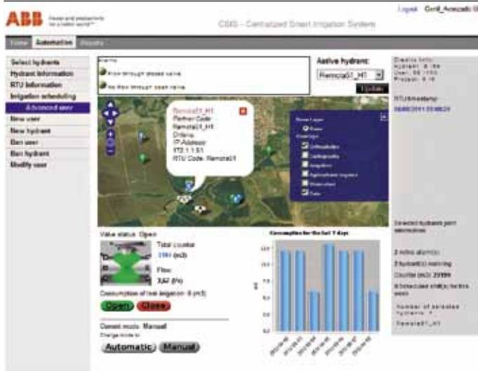
Neptuno a évolué en un « système centralisé d'irrigation intelligent » qui permet d'accéder à l'interface du superviseur sur Internet, en mode SaaS (*Software as a Service*). Le client n'a pas besoin d'infrastructures dédiées.
