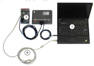
4. 将 24V 直流电源 (2) 连接到 CP405/CP408 (5) 和 AC500-eCo (3)。
