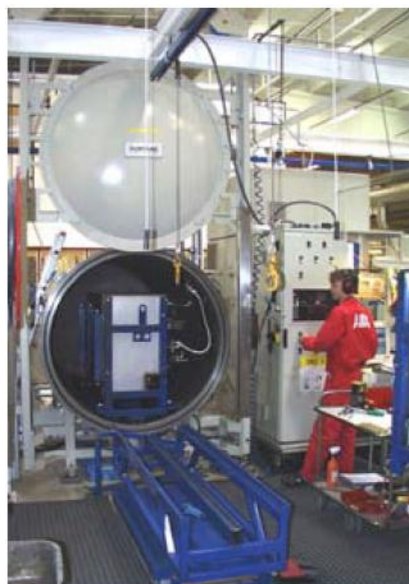
Рис. 18. Вакуумная камера для испытаний на герметичность.
