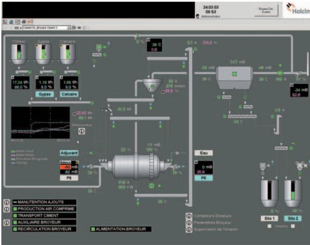
**Bild 8: Bedienerinterface der Zementmühle mit Dosiersystem**
