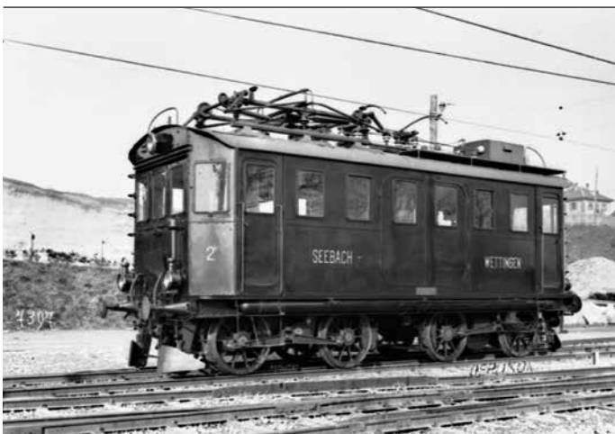
4 Locomotora experimental MFO n.º 2 con motores de tracción monofásicos
