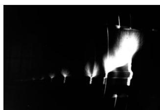
Avance à l'amorçage d'un PTS avec une caméra rotative haute vitesse.
