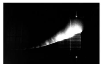
Amorçage sur la pointe d'un Pulsar photographié à l'aide d'une caméra rotative haute vitesse.
