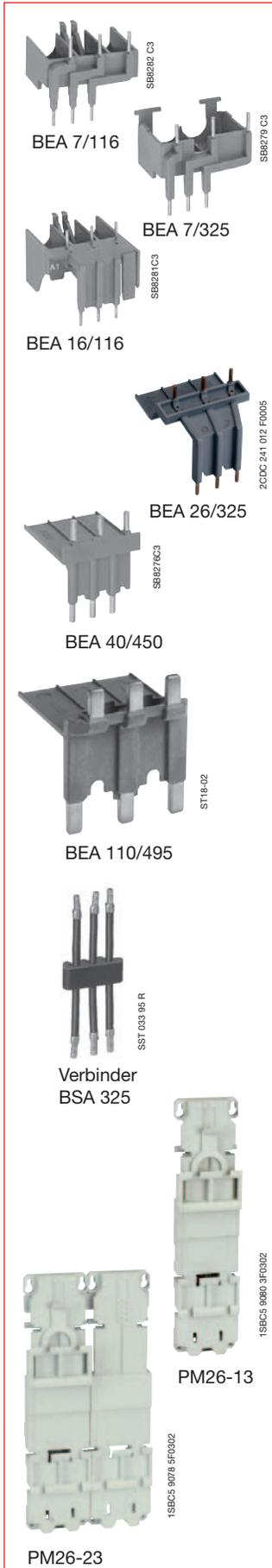
**Direktadapter BEA ..** ermöglichen die direkte Verbindung zwischen dem Motorschutzschalter und dem zugehörigen Schütz, die dann gemeinsam als **DOL-Starterkombination** der Zuordnung **Typ 1** bzw. **Typ 2** gemäß **IEC/EN 60947-4-1** verwendet werden, zugehörige Koordinationstabellen ab Seite 4/29.
