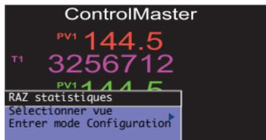
Les menus de niveau Opérateur sont utilisés pour réinitialiser les statistiques, sélectionnez la vue et pour accéder aux modes *Basique* et *Avancé* (via le *niveau d'accès*).
