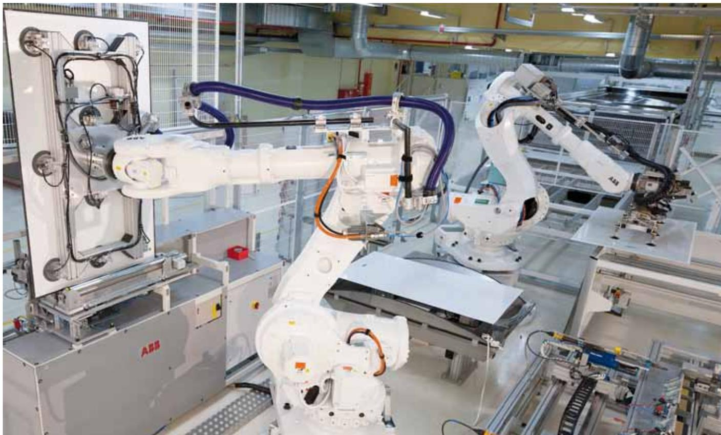
Der neue Tape-Roboter im Einsatz bei Conergy: Der Roboter gewährleistet eine Serienfertigung von Premium-Solarmodulen.
