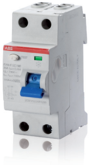
F202 Typ F, FI (RCCB) in zweipoliger Ausführung mit einem Bemessungsstrom von 25, 40, 63 A und einem Bemessungsfehlerstrom von 30 mA zum Schutz von einphasigen Stromkreisen.
