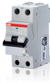
DS201 Typ F, kompakter FI/LS-Schalter (RCBO) (1P+N) mit einem Bemessungsstrom von 6...40 A, B- und C-Charakteristik und einem Bemessungsschaltvermögen von 10 kA in nur zwei Modulen.
