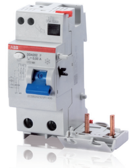
DDA 202 Typ F, FI-Blöcke (RCU) (zum Anbau an Sicherungsautomaten S202) in zweipoliger Ausführung mit einem Bemessungsstrom von 40 und 63 A sowie einem Bemessungsfehlerstrom von 30 mA – für schnelle und flexible Lösungen.
