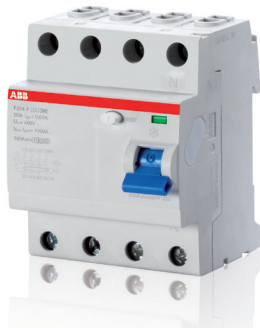
F204 Typ F, FI (RCCB) in vierpoliger Ausführung mit einem Bemessungsstrom von 25, 40, 63 A und einem Bemessungsfehlerstrom von 30 mA zum Schutz von mehreren einphasigen Stromkreisen mit einem einzigen Gerät.
