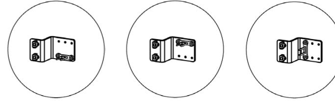
5. Fijar el actuador al soporte Z con los 2 tornillos M5x8.
