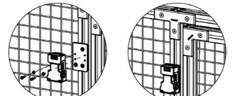
3. Um das Manipulationsrisiko zu verringern, montieren Sie den Standard-Betätiger auf der Z-Halterung wie im folgenden Beispiel A. Damit werden die Montageschrauben vom Schalter mit der Z-Halterung abgedeckt.
