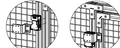
7. Vergewissern Sie sich, dass alle Schrauben gut angezogen wurden und die Nutensteinen richtig im Aluminiumprofil sitzen. Testen Sie die Funktion, indem Sie die Tür mehrmals öffnen und schließen.
