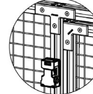
3. Para reducir el riesgo de manipulación, fijar el actuador sobre el soporte Z tal y como se indica en el ejemplo. A fin de cubrir los tornillos de montaje del interruptor con el soporte Z.
