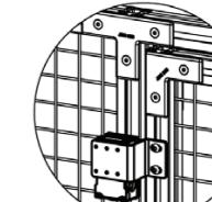
7. Verificar que todos los tornillos se encuentren bien apretados y que que las tuercas para perfil se encuentren correctamente posicionadas en la ranura del perfil de aluminio. Comprobar el correcto funcionamiento abriendo y cerrando la puerta un par de veces. Ajustar el soporte Z con el actuador si es necesario.
