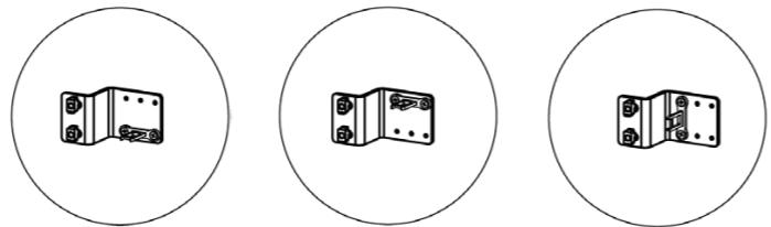
5. Montieren Sie den Betätiger mithilfe der beiden Schrauben M5x8 an dem Z-Beschlag.
