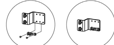
6. Montieren Sie den Z-Beschlag mit dem Betätiger am Türblatt. Justieren Sie den Z-Beschlag, bis die Betätiger genau in die Öffnung des Schalters passt.
