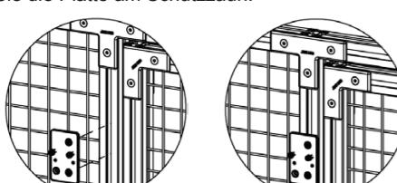
2. Montieren Sie den Schalter mithilfe der zwei beiliegenden Schrauben M5x18 durch die Langlöcher an der Platte. Zentrieren Sie den Schalter über der Befestigungsplatte, bevor Sie die Schrauben anziehen.
