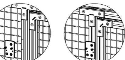
4. Nyckeln kan monteras på flera olika sätt, beroende på hur brytaren är monterad på staketet och om dörren/luckan är höger -eller vänsterhängd. Se monteringsexempel nedan.
