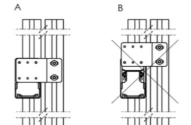
4. Der Standard-Betätiger ist auf verschiedene Weisen montierbar, je nachdem, wie der Schalter am Sicherheitszaun montiert wurde und ob die Tür eine Rechts- oder Linksaufhängung hat. Bitte beachten Sie dazu die folgenden Montagebeispiele.
