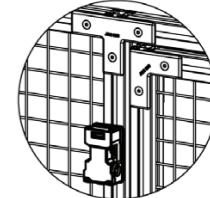
3. För att minska risken för manipulering av brytaren, skall nyckeln monteras på Z-beslaget enligt exempel A nedan. Fästet för nyckeln ska täcka brytarens monteringsskruvar.
