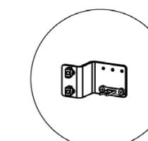
6. Montera nyckelfästet på dörrbladet och justera fästet tills nyckeln passar perfekt i brytarens öppning.
