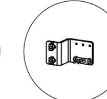
6. Montar el soporte Z con el actuador sobre el perfil de la puerta. Ajustar el soporte Z hasta que el actuador coincida perfectamente con la apertura del interruptor.
