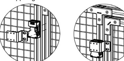
7. Kontrollera att alla skruvar är åtdragna och att T-spärsmuttrarna vrider ut ordentligt i aluminium profilen. Gör funktionskontroll genom att öppna och stänga dörren några gånger. Justera nyckelbeslaget vid behov.
