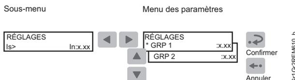
Fig. 4.2.2.2.-1 Réglage des paramètres dans les groupes de réglages 1 et 2
