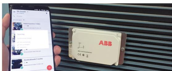
**Hinweis:** Stellen Sie sicher, dass die Halterung so auf die Kühllamelle gesteckt werden kann, dass die benachbarten Kühllamellen das Anbringen des Sensors nicht verhindern.
