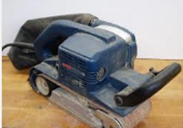
Fig. 3 Protección del punto de contacto de la lijadora de banda
