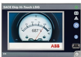
5 Emax E1.2 dotés de modules Ekip Touch LSI et Ekip Measuring
