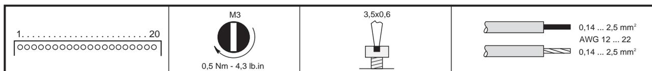
Figure 20: Couples de serrage et dimensions des câbles (1 mm = 0,0394 pouce)
