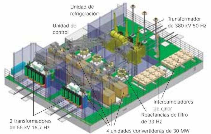
nal de 103 MW, obtenida con cuatro convertidores estándar de 30 MW. La capacidad de sobrecarga incorporada permite al cliente seguir recibiendo la potencia nominal de 413 MW, incluso si una de las cuatro estaciones convertidoras no está en servicio. Cada unidad convertidora tiene los siguientes componentes principales:
