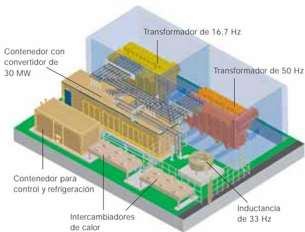
de 30 MW que se alimentan de la red nacional a 50 Hz/110 kV y la convierten a 16,7 Hz/110 kV. De esa forma se dispone de un total de 60 MW de energía eléctrica para la red ferroviaria sin pérdidas de transporte, gracias a su proximidad a la central de generación. El primer convertidor de 30 MW entró en servicio comercial en julio de 2009 → 4.
