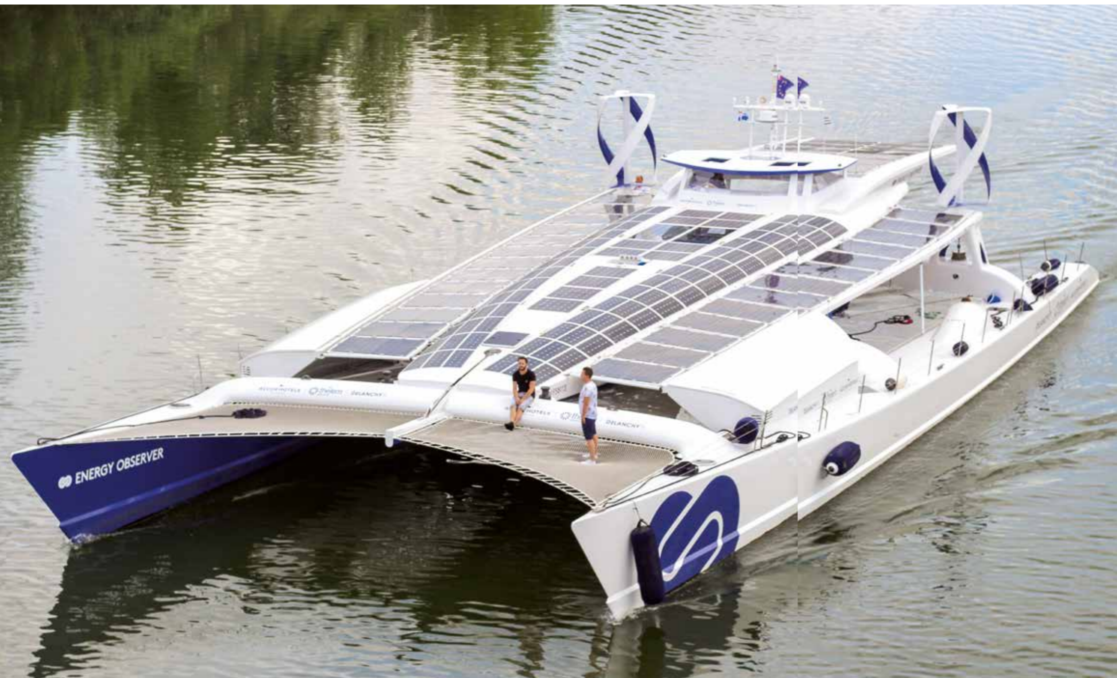
09 El Energy Observer es el primer buque de hidrógeno del mundo. Este antiguo barco de regatas no emite gases de efecto invernadero ni partículas finas y produce hidrógeno a bordo sin carbono procedente del agua del mar.
