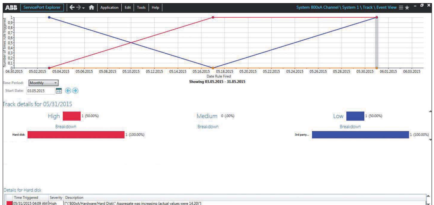
Bild 3: Typische Darstellung für jeden Optimization Channel. Der obere Bereich zeigt die „Track“-Ansicht mit den anlagenspezifischen Triggern, die ausgelöst wurden.
