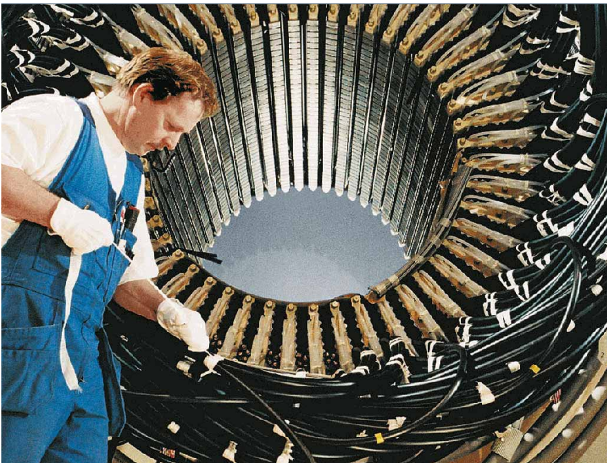
7 Motor de alta tensión con devanado de cable en la plataforma Troll en el Mar del Norte.
