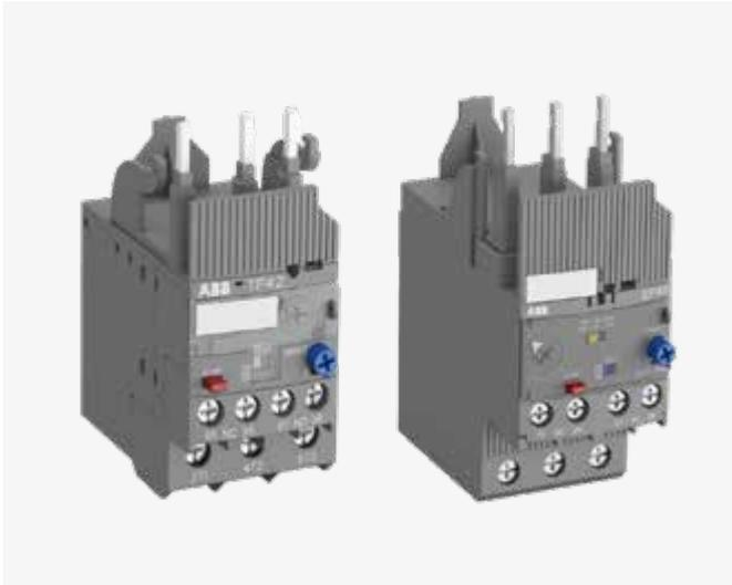
Überlastrelais bieten zuverlässigen Schutz für Motoren bei Überlastung oder Phasenausfall. Thermische Überlastrelais sind wirtschaftliche elektromechanische Schutzeinrichtungen für den Hauptstromkreis und bieten zuverlässigen Überlastschutz für Motoren. Elektronische Überlastrelais verfügen über sehr breite Stromstellbereiche und erlauben die Einstellung einer Auslöseklasse. Beide können zusammen mit Schützen eine kompakte Starterlösung bilden.
