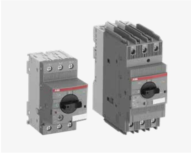
Motorschutzschalter sind elektromechanische Schutzeinrichtungen für den Hauptstromkreis. Sie werden hauptsächlich zum Absichern gegen Kurzschluss, Überlast und Phasenausfall eingesetzt und erlauben zusätzlich das manuelle Ein- und Ausschalten von Motoren. Sicherungsloser Schutz spart Kosten, Platz und sorgt für eine schnelle Reaktion im Kurzschlussfall, indem der Motor innerhalb von Millisekunden abgeschaltet wird. Starterkombinationen werden zusammen mit Schützen aufgebaut.
