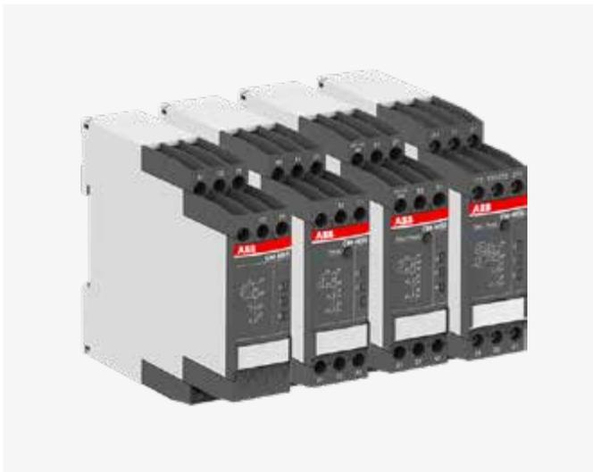
Die Thermistormotorschutz-Relais der Baureihe CM-MSS überwachen die Wicklungstemperatur von Motoren, in denen PTC-Temperatursensoren installiert sind. Diese Sensoren sind in die Motorwicklungen integriert und messen so die Motorwärme direkt. Durch diese direkte Temperaturmessung können die Thermistor-Motorschutzrelais verschiedene Motorzustände wie Überhitzung, Überlast und unzureichende Kühlung auswerten.
