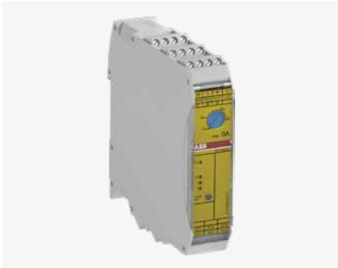
Der elektronische Kompaktstarter HF von ABB bietet mehr Funktionen auf weniger Raum. Die kompakte Einheit ist nur 22,5 mm breit und eignet sich für dreiphasige Motorlasten bis 3 kW - 400 V AC. Es sind Direkt- und Wendestarter mit Überlastschutz und Not-Halt-Versionen erhältlich. Die Baureihe ist perfekt für Anwendungen mit sehr häufigen Schaltvorgängen, wie z.B. Verpackungsmaschinen, Förderer, Pumpen, Kompressoren und Werkzeugmaschinen.
