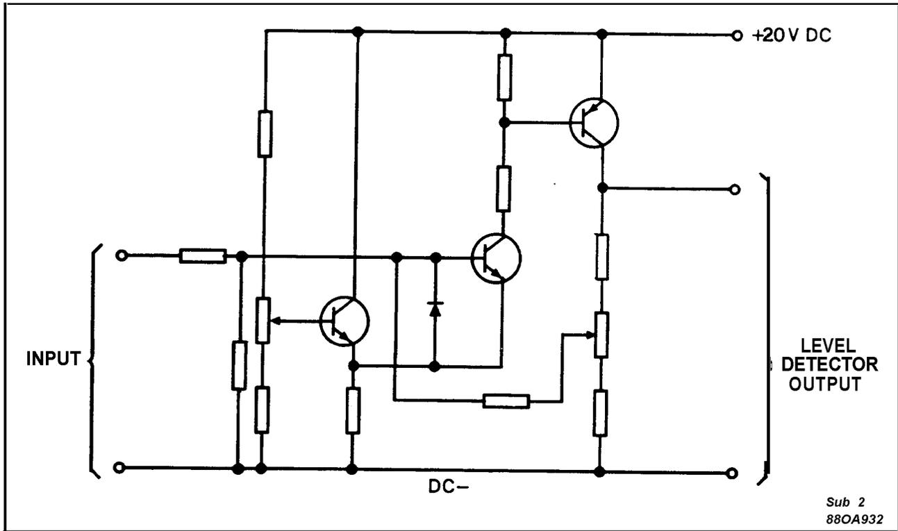
Fig. 8. Level Detector.
