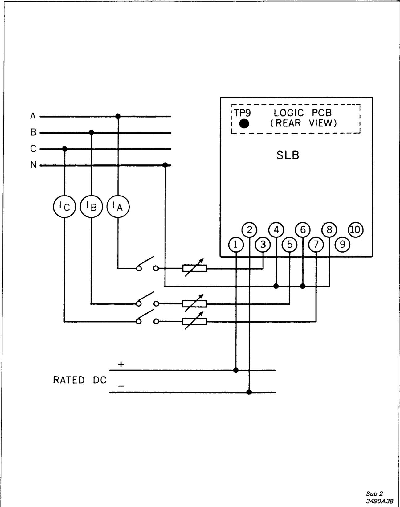
Fig. 14. Relay Test Circuit.
