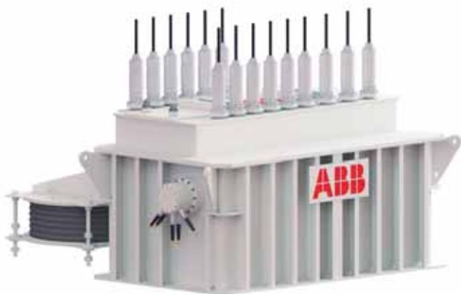
基于广泛应用的 ABB 真空断路器技术，油浸式部件通过了循环和静态压力测试，并完成了 IEC/IEEE 测试项目。断路器的质量鉴定还包含了额定短路电流和最大非对称电流下  $16\frac{2}{3}$  Hz 电源的通断测试。所生产的若干种断路器模块连同相关电气和光学控制接口一起接受了各种测试，包括运行和运输过程中的电气测试、机械耐久性测试和振动测试等。
