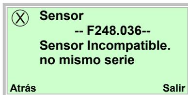
Cuando se opera una instalación mixta aparece este mensaje de error.
