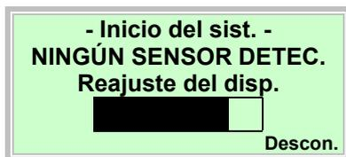
Después de conectar el aparato, los datos de calibrado del sensor de caudal y los ajustes del transmisor se leen del SensorMemory y se importan en el transmisor. Si no es posible establecer la comunicación con la SensorMemory<sup>1)</sup>, en el indicador LCD aparecerá el siguiente mensaje.
