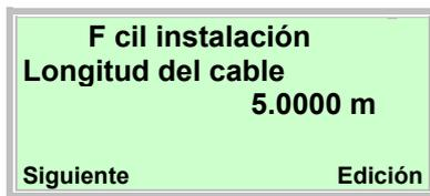
Introducción de la longitud del cable de señal entre el transmisor y el sensor. Hay que introducir 0,01 m en dispositivos de diseño compacto.
