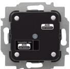
Para transmitir comandos de encendido y apagado, regulación y persianas a un actuador ABB-free@home®. Elementos de control: contactos táctiles arriba/abajo. Pilotos: LED a modo de luz de orientación o como indicación del estado de conmutación. Grado de protección: IP 20. Temperatura de funcionamiento: -5 °C a 45 °C. Profundidad de montaje: 9 mm. Solo para uso en combinación con interruptores de tecla ABB-free@home® de un canal ref. SR-1-85, SRL-1-85, SRD-1-85, SRB-1-85 y SRS-1-85.
