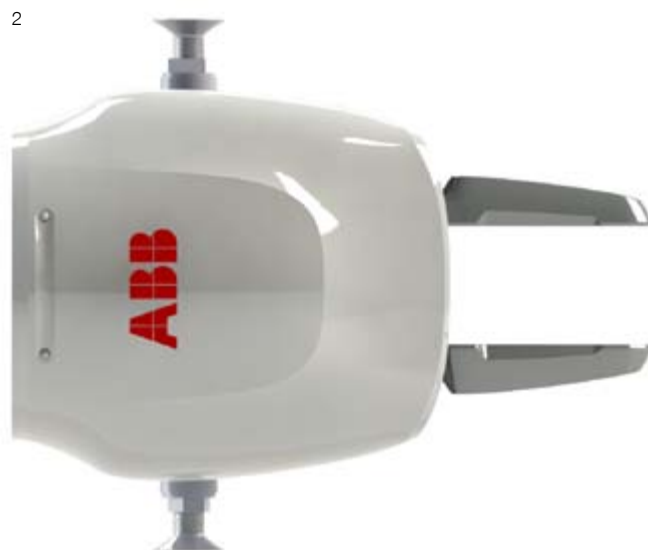
2. Chapadlo se servopohonem, dvěma vakuovými savkami a kontrolkami stavu
