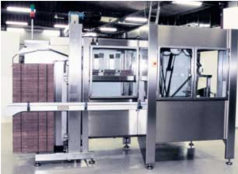
11 Intégré à une machine d'emballage FlexWrapper™, un IRB 340 saisit et dépose des cartons prêts et personnalisés.
