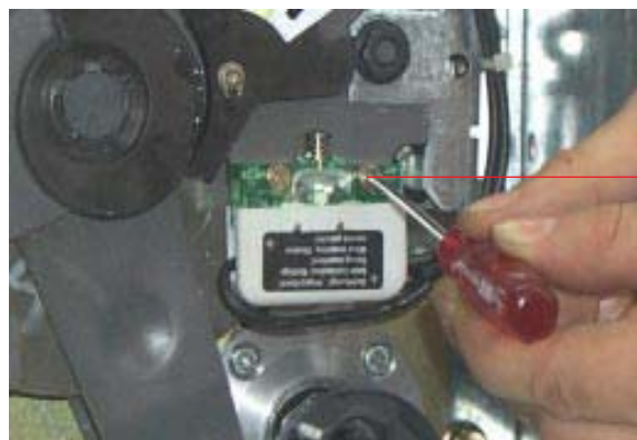
Svitare viti di fissaggio microinterruttore (2) Unscrew the microswitch fixing screws (2)
