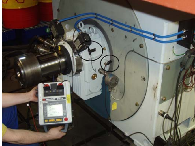
図 7-3 スリーブベアリングの絶縁抵抗を測定する
