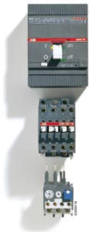
être équipés du déclencheur électronique à microprocesseur PR211/P (I). Ils sont surtout employés pour la protection de moteurs de grande puissance et, grâce au réglage de la protection contre les courts-circuits de 1,5 à 12 fois, ils permettent de choisir la valeur de déclenchement optimale pour n'importe quel type de moteur.
