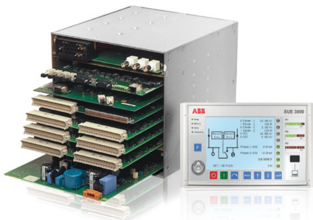
Рис. 3-2 Устройство SUE 3000 (Центральный блок и пульт управления)
