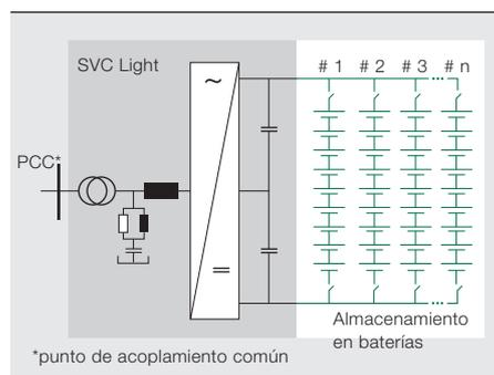
La tecnología permite el control independiente y dinámico de las energías activa y reactiva en un sistema eléctrico.
