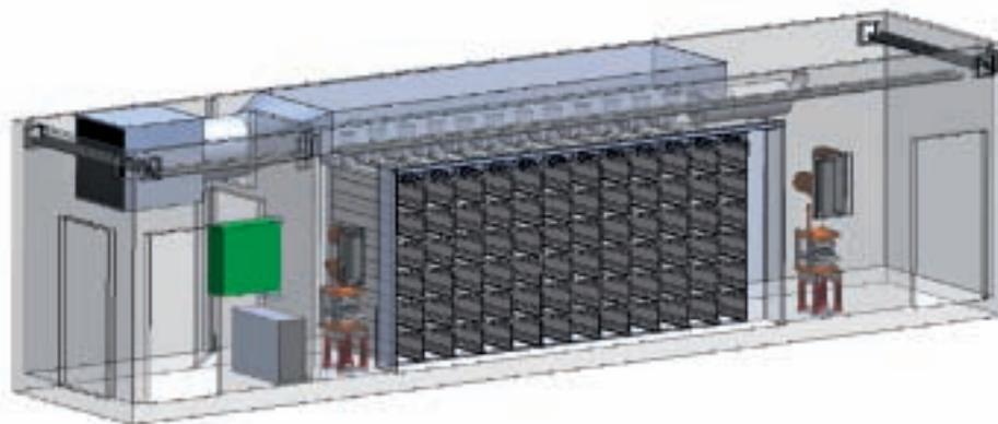
El VSC está formado por un IGBT y semiconductores de diodo → 3. Para soportar la tensión requerida en las válvulas, los semiconductores están conectados en serie. En el VSC se utiliza refrigeración con agua, lo que se traduce en un diseño compacto del convertidor y capacidad para soportar altas intensidades.
