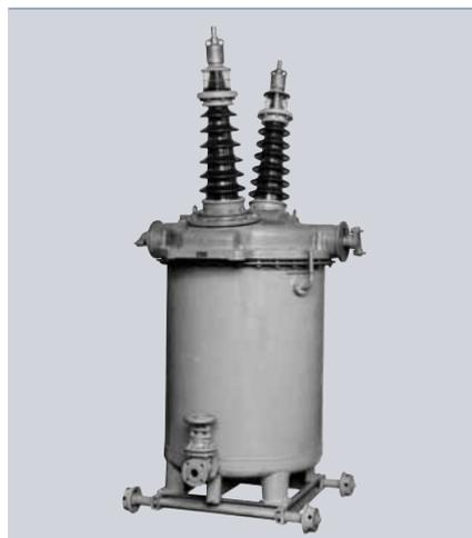
ölarme Leistungsschalter, die auf diesen klobigen frühen Modellen basierten, wurden bis in die 1980er Jahre eingesetzt. Das Grundprinzip des ölarmen Leistungsschalters ist in **3** dargestellt. Bildet sich im Öl ein Lichtbogen, verdampft das Medium, und es entsteht eine Blase um den Lichtbogen. Dieses stark verdichtete Gas, das zu fast 80 % aus Wasserstoff besteht, hemmt die Ionisation und strömt durch die Kanäle, die den
