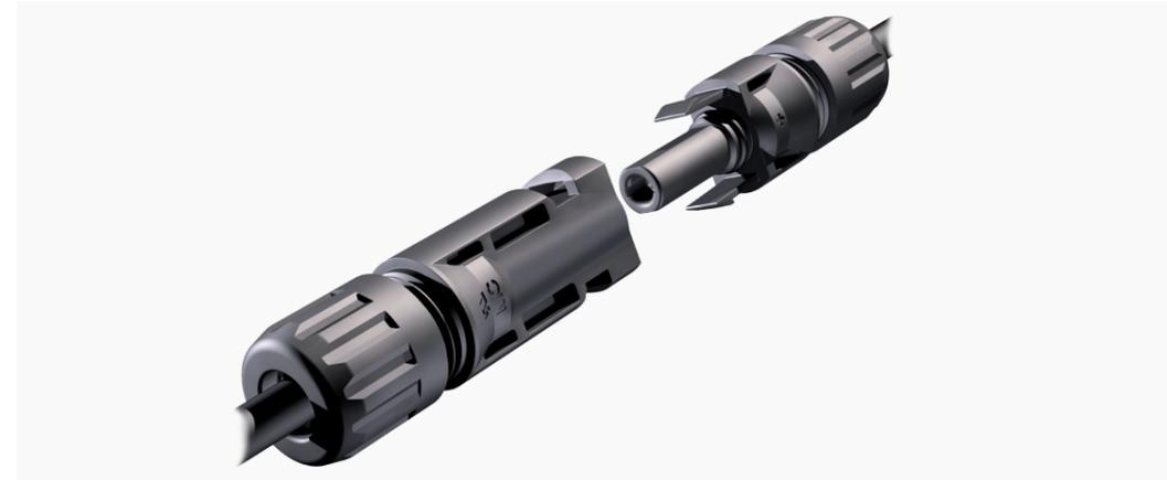
Os conectores devem ser manuseados por pessoas competentes ou instruídas e nunca devem ser desconectados sob carga; a desconexão sob carga pode provocar um arco elétrico em CC, podendo causar danos permanentes aos conectores. Os conectores devem ser de um tipo que só possa ser desconectado por meio de uma chave ou ferramenta, ou instalado no interior de um compartimento que só possa ser aberto por meio delas.
