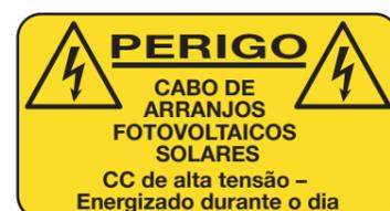
Além dos requisitos da IEC 60364, deve haver uma separação entre circuitos de CC e CA, de acordo com os mesmos requisitos para a separação de níveis de tensão diferentes.
