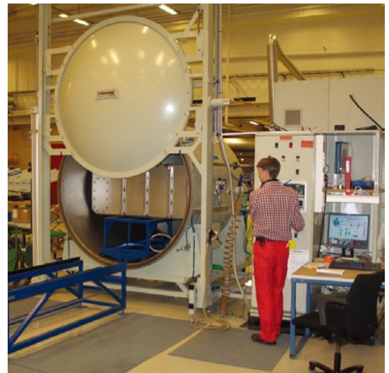
用于气体检漏试验和SF 6 充填的真空罐
