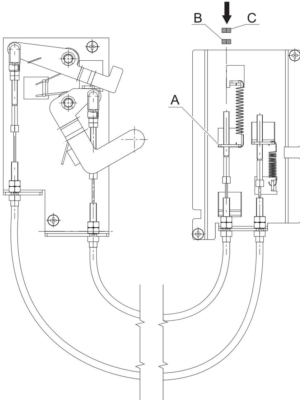
1. Abbassare la leva **A** fino a fine corsa.
