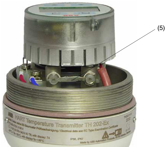
Bild 4-3 Geöffnetes Gerät mit Anzeiger (5) Kurzschlussbrücke in Park-Position ohne Funktion bei Geräten mit Anzeiger
